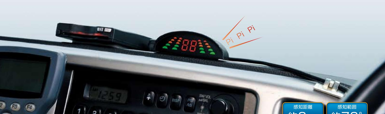
トラック・バス専用 業務用バックセンサー TP-BS01は、後退事故防止用のバックセンサーです。4つのセンサーで広範囲に障害物の存在を感知し、LEDによる距離表示とブザー音で知らせます。ブザー音は距離で変化しますので、モニター部を凝視しなくてもある程度の距離がわかります。
